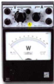
On peut mesurer directement la puissance électrique avec un **wattmètre**.
