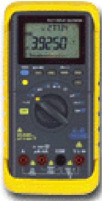
On mesure la tension électrique entre deux points d'un circuit avec un **voltmètre** analogique ou numérique branché aux bornes des deux points. On dit aussi branché en parallèle ou en dérivation.
