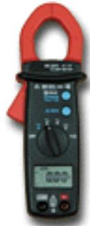
Exemple de pince multifonctions permettant les mesures de tension, courant et puissance
