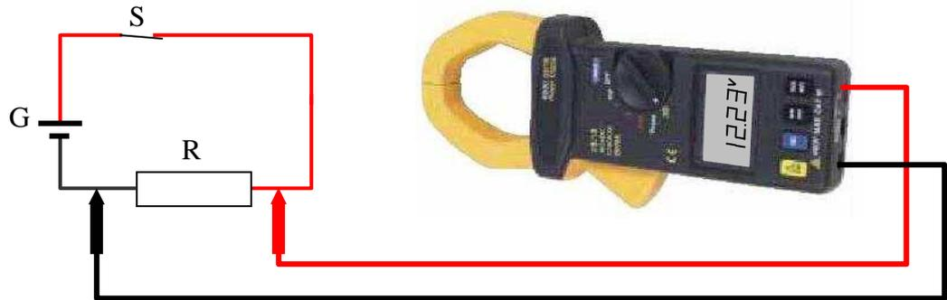
➤ Mesure d'une intensité électrique continue
